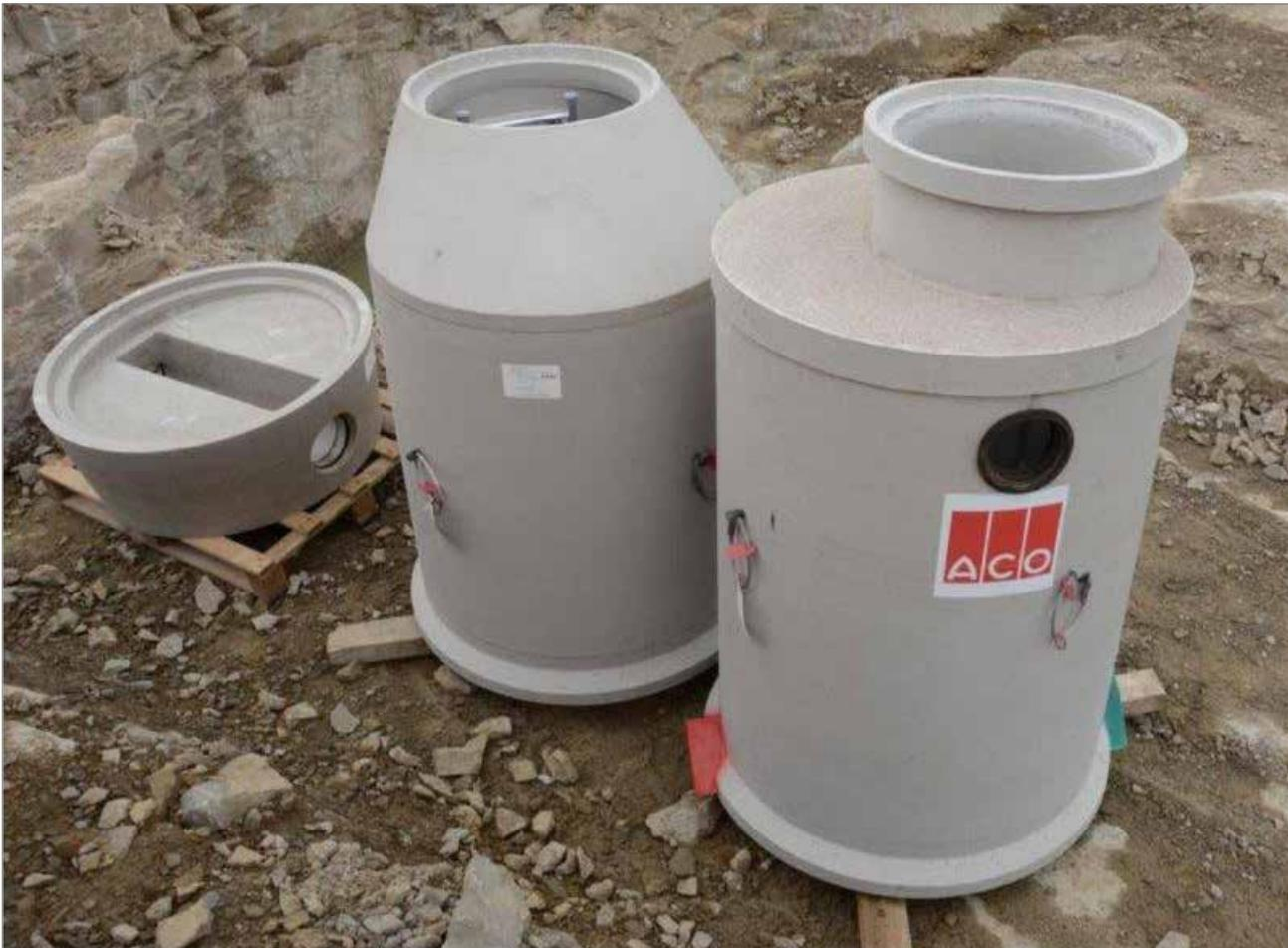
Kontroll- und Einstiegsschächte werden mit dem Komplettschacht-system in zwei Teilen gefertigt. Der Massschachtboden wird dabei mit allen benötigten Anschlüssen vorgefertigt. Der passende Aufbau wird in der benötigten Höhe inkl. Leitern und Einstiegshilfen in einem Stück gefertigt. So kann der Schacht in nur zwei Zügen versetzt werden.
