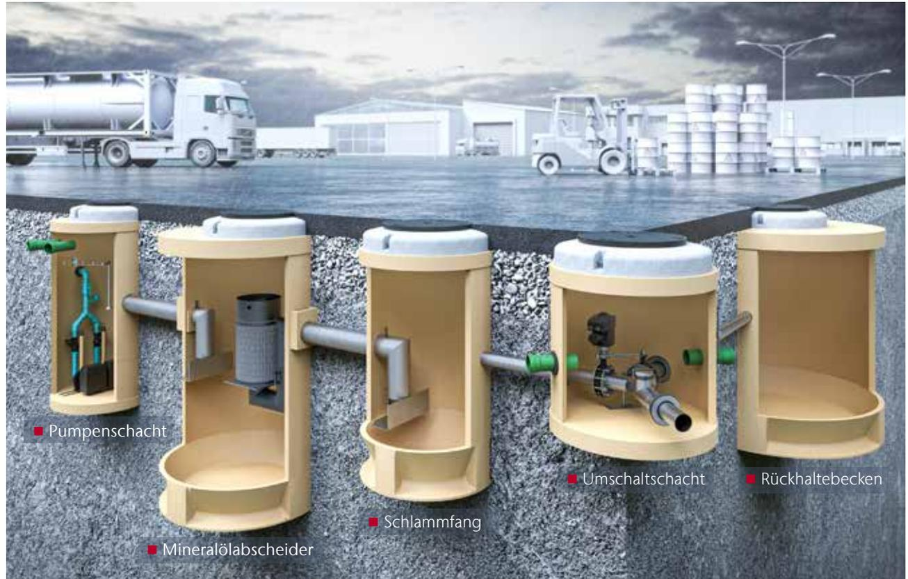
Durch die vorgeschriebene Alarmanlage im Abscheider Klasse I (Abscheiderlinie) wird eine erforderliche Entsorgung des Abscheiderinhalts beim Erreichen von 80 % der maximalen Leichtflüssigkeitsspeichermenge signalisiert. Über den Aufstausensor der Alarmanlage wird ein Überschreiten des maximal zulässigen Betriebswasserstands signalisiert (z. B. Rückstau aus dem öffentlichen Kanal oder Schwimmerabschluss).
